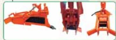
■ Sulcadores com dispositivo destorroador
