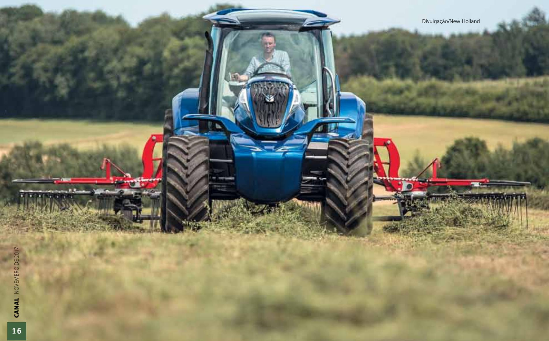
mesma potência e torque que o equivalente a diesel. Essa é a segunda versão do protótipo, sendo a primeira apresentada ainda em 2016. O trator possui a mesma durabilidade e intervalos de serviços e uma operação mais silenciosa, com nível de ruído reduzido em até 3 dBA, ou seja, diminuição de cerca de 50% no ruído.
