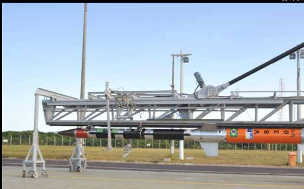
**Plataforma para o lançamento do foguete VS-30, movido a etanol**
