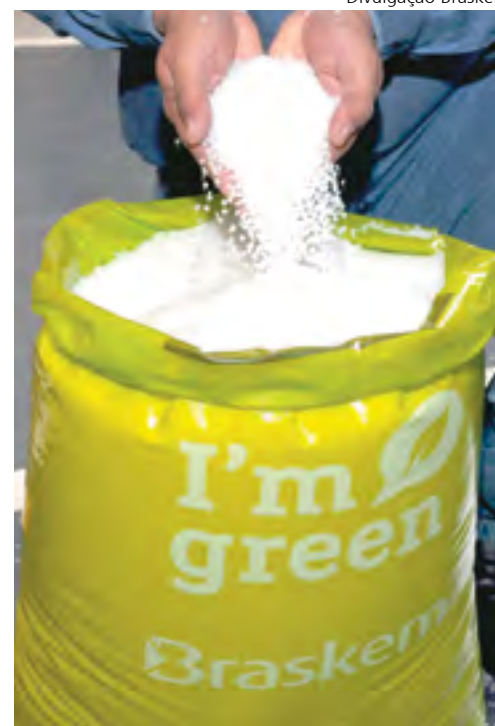
O "polietileno verde" é um produto que utiliza como matéria-prima o etanol
