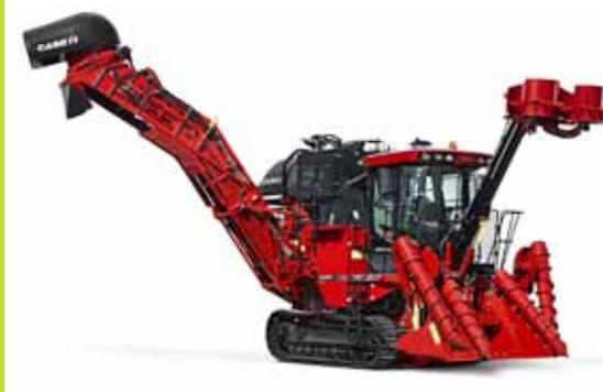
frontal do equipamento e um pendente, para utilização 360°. Já os novos rolamentos dos rolos alimentadores tiveram uma redução de 83% no seu tempo de troca, de 15 horas, para duas horas e meia para troca de todos os rolamentos. A centralização dos pontos de lubrificação é outro diferencial que possibilita realizar a tarefa em 30 minutos (a cada 50 horas de colheita).
